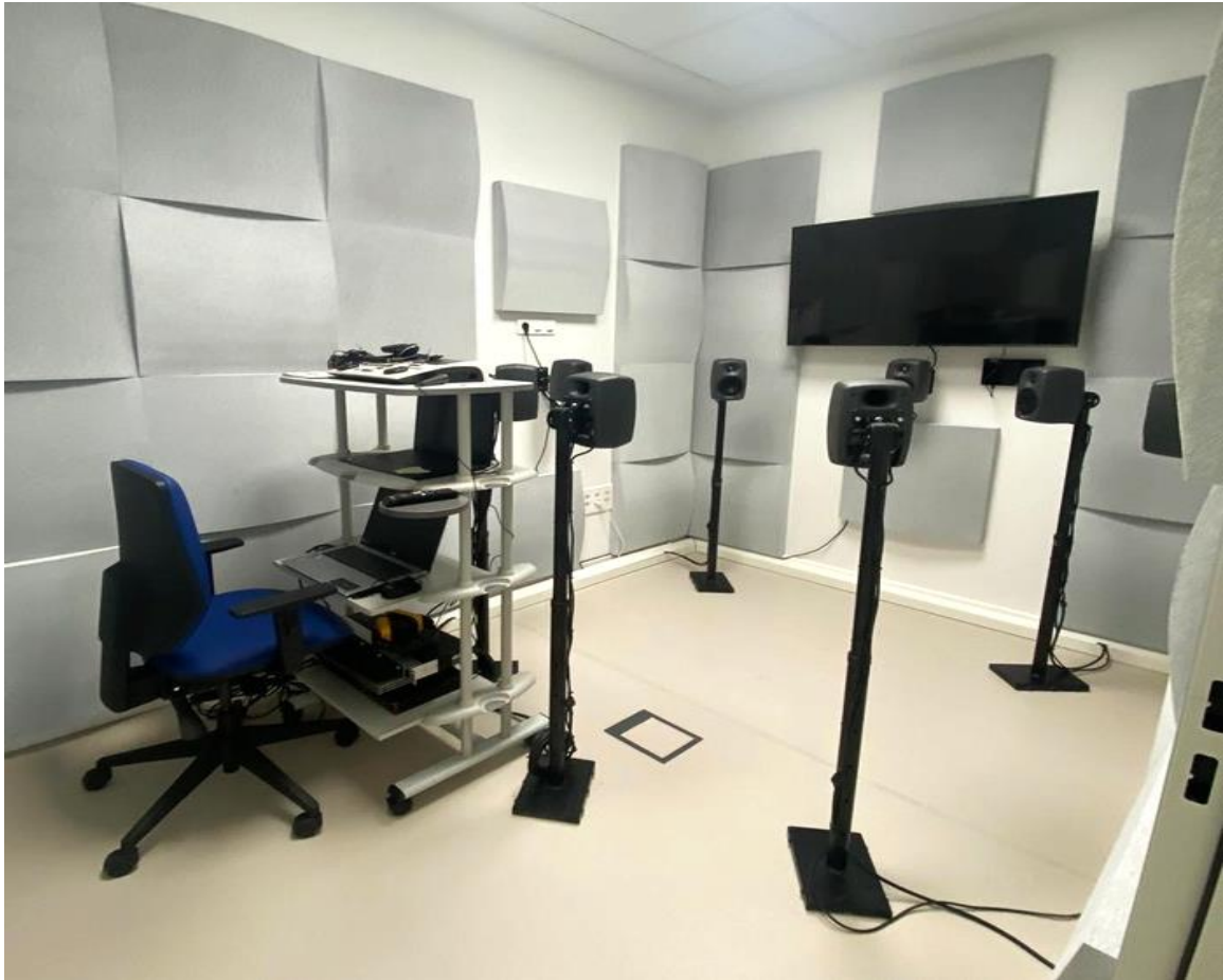
Figura 3. Laboratorio de Audiología del Servicio de Otorrinolaringología del Hospital Universitario Virgen Macarena. Sala de entornos sonoros para determinar la localización de la fuente sonora y de la confortabilidad de la persona explorada en distintos ambientes sonoros.
